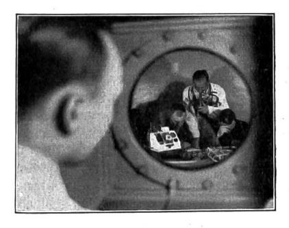
Blick in die von d. Aussenluft dicht abgeschlossene Kabine. Durch die Beobachtungsluke ist es den Ärzten möglich, das Verhalten der angehenden Flieger von den ersten Anzeichen der "Höhenkrankheit" an zu verfolgen.
