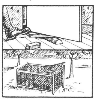
unter. Dadurch wird die Türe in die Höhe gehoben, hängt aber trotzdem nicht aus. Mit einem andern Holzklotz unterlegt man die Türe, damit man nicht ständig auf dem Brett stehen bleiben muss. b. Um ein altes Kindergitter, oder ein aus Holzleisten entsprechend gefertigtes Gestell, wird ein Drahtgeflecht gespannt und angenagelt. Darauf bringt man mit 2 Scharnieren den Deckel an. Auch
