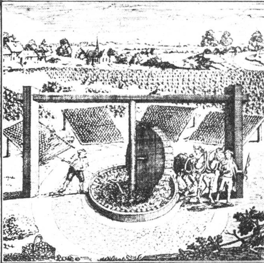
Waid-Mühle aus dem 18. Jahrhundert. In früheren Zeiten verwendete man zum Blaufärben der Gewebe fast ausschliesslich die aus den Blättern der Waidpflanze gewonnene Farbe. Die Pflanzen wurden in der Waid-Mühle mittelst eines grossen Steines zerquetscht, dann zu apfelgrossen Kugeln geballt und diese getrocknet. Rings um die Mühle sind die Trockengestelle sichtbar.
