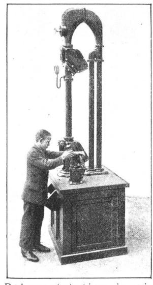
Rohrpoststation in einem schweizerischen Telegraphenamt. Der Bote lässt eine Büchse, Telegramme enthaltend, in die Rohrleitung gleiten. Mittelst Saug- oder Druckluft wird die Rohrpostbüchse in einer Geschwindigkeit von 60 km in der Stunde durch die Leitung gejagt.
