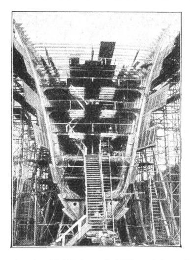
Während das Schiff noch seine wöchentlichen Fahrten ausführt, wird im Dock schon das neue "Vorschiff" gebaut. Blick in das Vorschiff.
