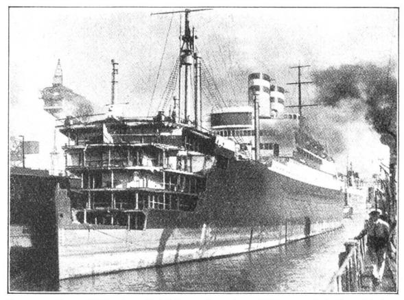
Der vordere Teil des Schiffes, der dem Wasser bei der Fahrt zuviel Widerstand bot, wird abgebrochen ("abgewrackt").
