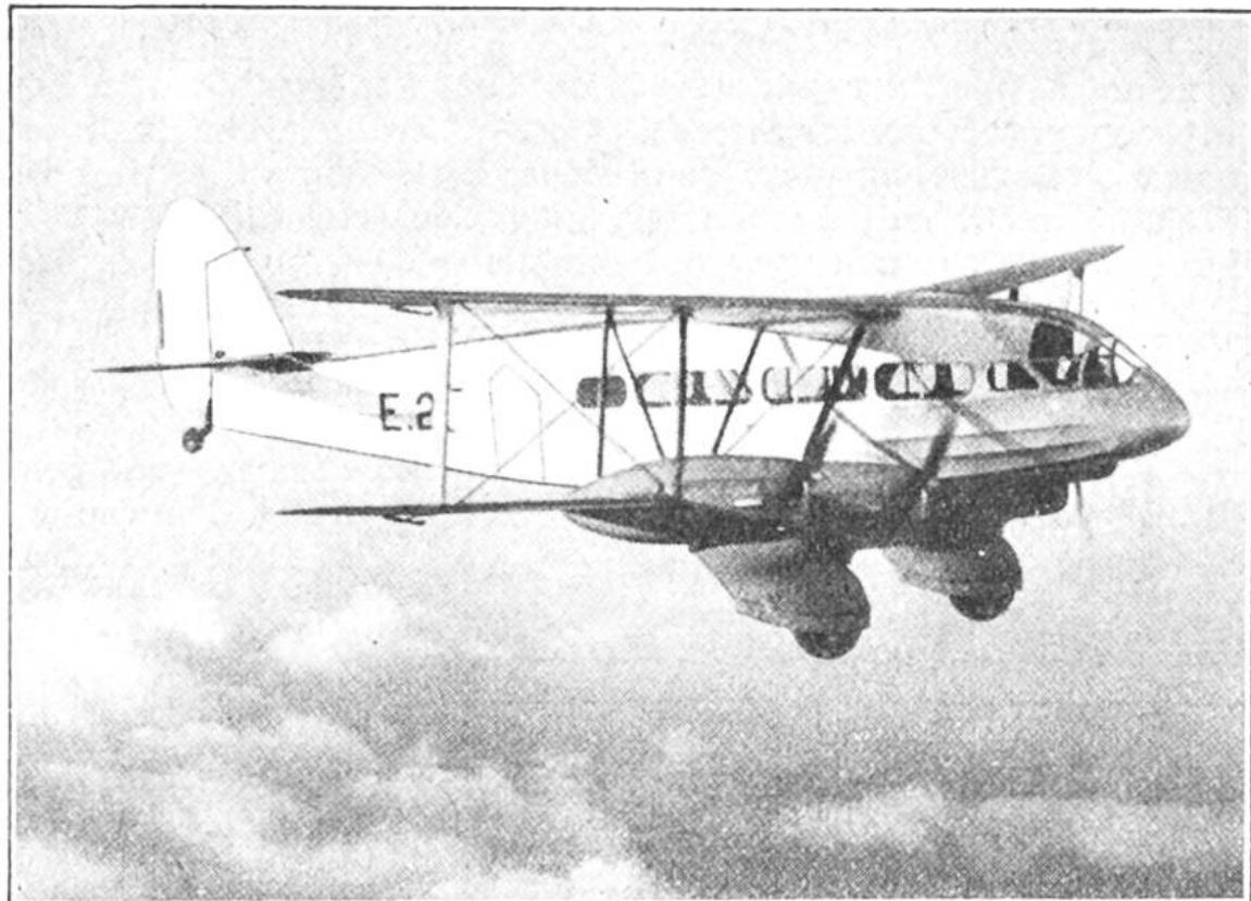
Modernes englisches Verkehrsflugzeug, bestimmt für die Fahrten zwischen Australien und Singapore. Das Flugzeug enthält einen geräumigen Salon für 12 Fahrgäste. Es erreicht eine Geschwindigkeit von 300 km in der Stunde. Aus der Ruhe kann es in einer Minute 400 Meter, in 2 Minuten 770 Meter hoch steigen.
