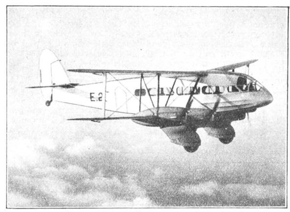
Modernes englisches Verkehrsflugzeug, bestimmt für die Fahrten zwischen Australien und Singapore. Das Flugzeug enthält einen geräumigen Salon für 12 Fahrgäste. Es erreicht eine Geschwindigkeit von 300 km in der Stunde. Aus der Ruhe kann es in einer Minute 400 Meter, in 2 Minuten 770 Meter hoch steigen.
