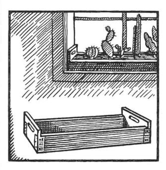
und Breite des Gesimses entspricht. An den beiden Schmalseiten, die etwas höher sind, sägen wir Oeffnungen von etwa 10 cm Länge und 2 cm Höhe ein, um so einen Griff zu erhalten. Die einzelnen Brettchen werden durch umgebogene Blechstreifen zusammengehalten. Schliesslich lässt sich das Kistchen anstreichen. Die Kakteentöpfe werden Sand oder Torfmull gebettet.
