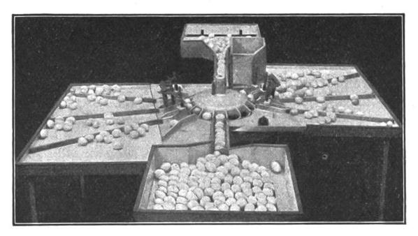
Sortiermaschine, welche Eier durchleuchtet, die schlechten ausscheidet, die guten stempelt.
