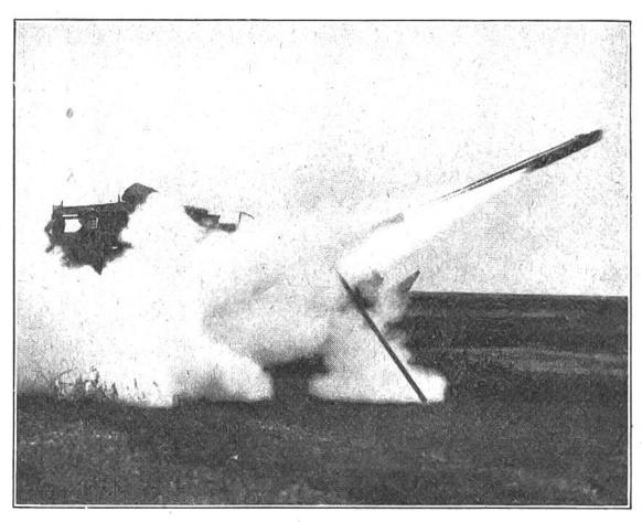
Die Küstenwache bei Rettungsübungen mit dem Raketengerät, mit dem eine Leine an Bord gestrandeter Schiffe geschossen wird.
