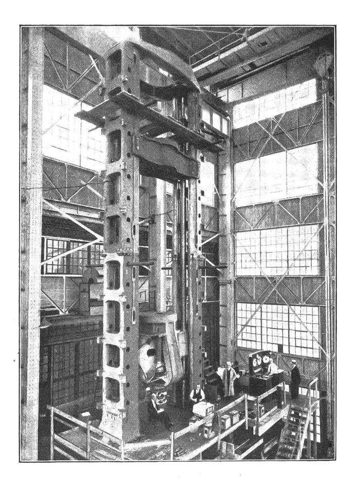
Dieser Riese unter den Maschinen prüft mit seinen ungeheuren Kräften Eisenbalken und technisches Konstruktionsmaterial auf dessen Zug- und Druckfestigkeit.
