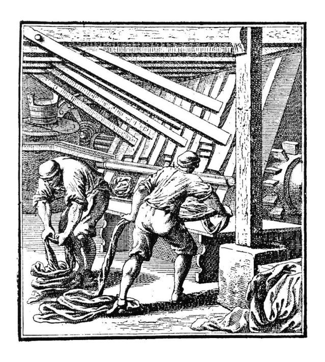
Tuch-Walken. Gewobene Wollstoffe werden gewalkt, damit die Stoffasern sich verfilzen. Zu diesem Zweck wurden im Altertum die Stoffe in einer Lauge mit Füssen getreten und schliesslich mit Stöcken geschlagen, mit Disteln rauh gemacht und geschoren. Unser Bild zeigt ein Walkwerk mit Hämmern, das ein Wasserrad betreibt. Heute werden zum Walken die Stoffe, zu Strangenform gewunden, zwischen zwei Walzen hindurchgepresst.
