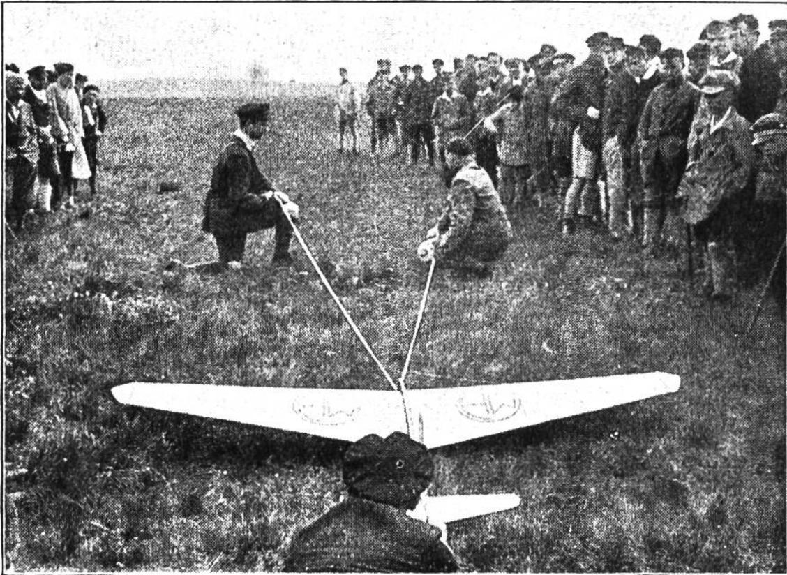
Gestartet werden die kleinen Modelle auf gleiche Weise wie die richtigen Segelflugzeuge: ein gespanntes Gummiseil schnellst sie in die Luft empor.
