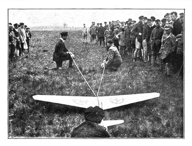
Gestartet werden die kleinen Modelle auf gleiche Weise wie die richtigen Segelflugzeuge: ein gespanntes Gummiseil schnellt sie in die Luft empor.
