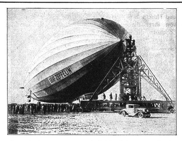
Der Ankermast ersetzt für kürzeren Aufenthalt die kostspielige Luftschiffhalle.
