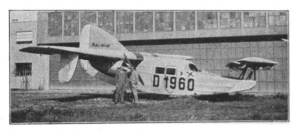
Das neuartige Flugzeug "Ente", bei dem das Schwanzende nach vorn verlegt ist. Der Führer sitzt an der mit x bezeichneten Stelle über der Ziffer 0. Wer das Flugzeug zum ersten Mal in der Luft sieht, glaubt, es fliege rückwärts.
