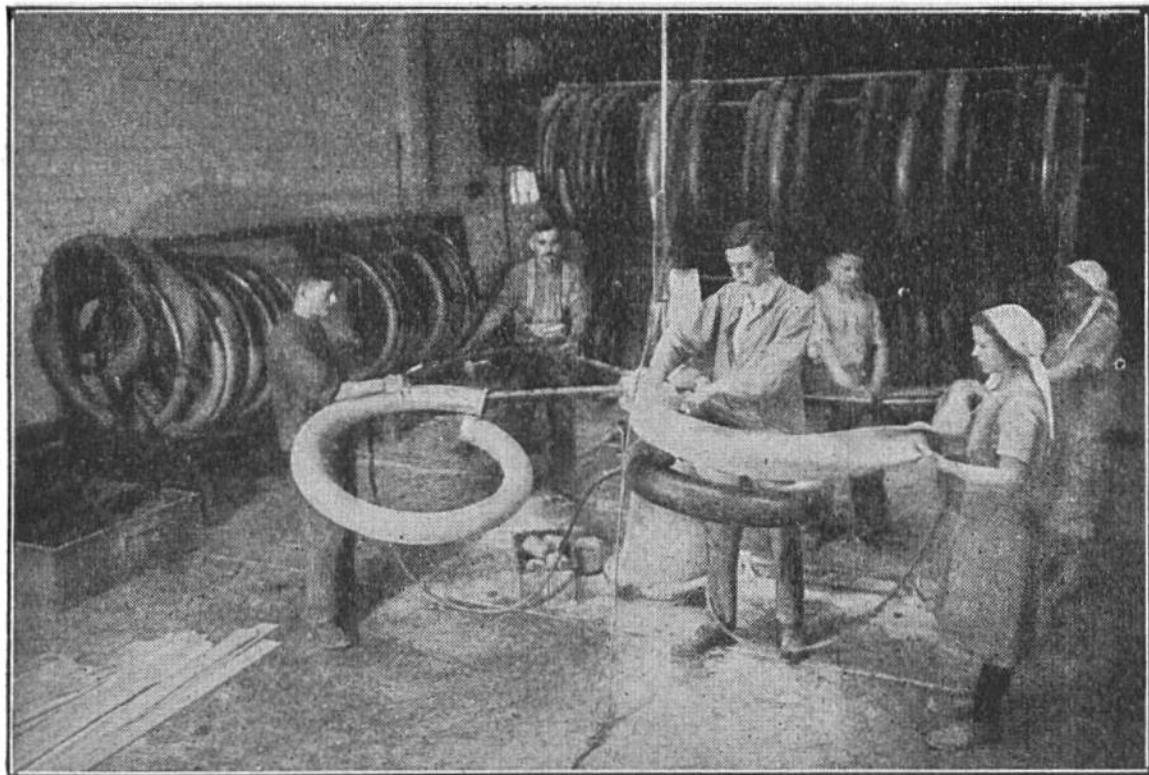
Die Herstellung der Schläuche. Lange Gummistreifen werden um glatte Rohre („Heizdorne“ genannt) gelegt, der Länge nach zusammengeklebt und dann vulkanisiert.
