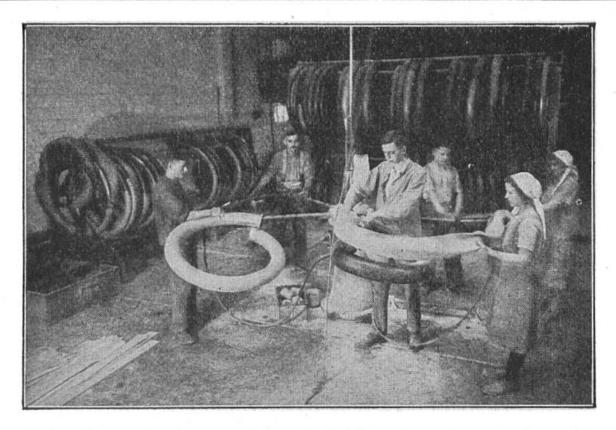
Die Herstellung der Schläuche. Lange Gummistreifen werden um glatte Rohre ("Heizdorne" genannt) gelegt, der Länge nach zusammengeklebt und dann vulkanisiert.
