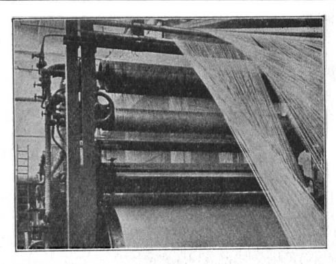
Teilansicht der Maschine, die das "Cordgewebe" herstellt. Zahlreiche Fäden laufen nebeneinander über Walzen und werden dort gummiert. Der verbindende Gummi ersetzt den beim Kreuzgewebe notwendigen Schussfaden.
