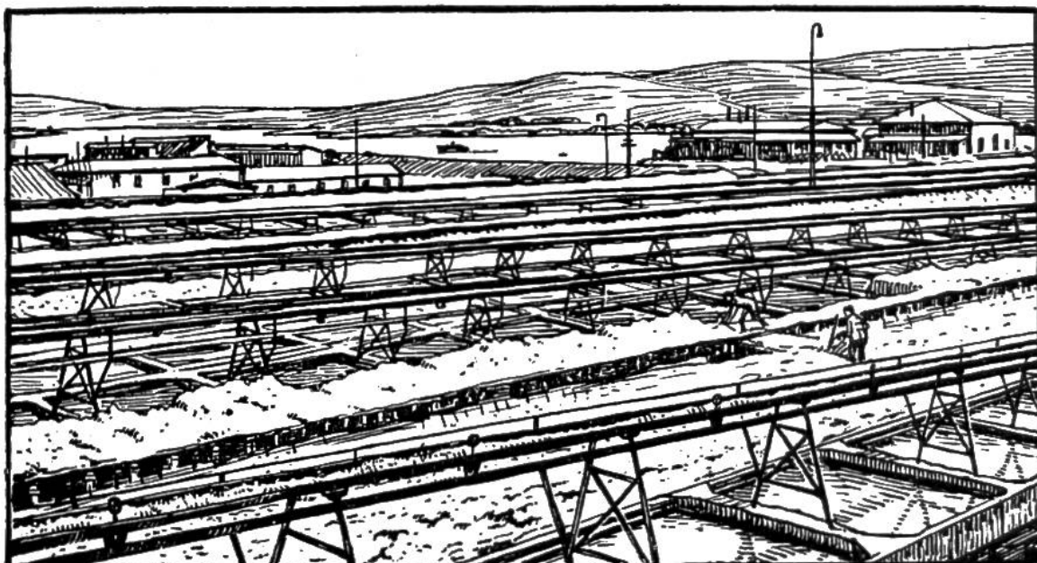
Bleichen und Verladen des Salpeters in Chile. Der durch Auslaugen gewonnene Salpeter trocknet auf grossen Bleichen und gelangt dann, in Säcke gefüllt, zur Verschiffung.
