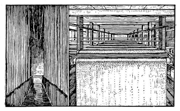
Fabrikation von Linoleum. Links: Sein Hauptbestandteil, das Leinöl, wird zu Linoxyn verdickt, indem im Abstand von 5 zu 5 cm Tücher gespannt sind, über die das Leinöl bei gleichzeitig reichlich warmer Luftzufuhr täglich gegossen wird. Rechts: Die fertigen Linoleumstücke hangen einige Wochen zum Trocknen auf.
