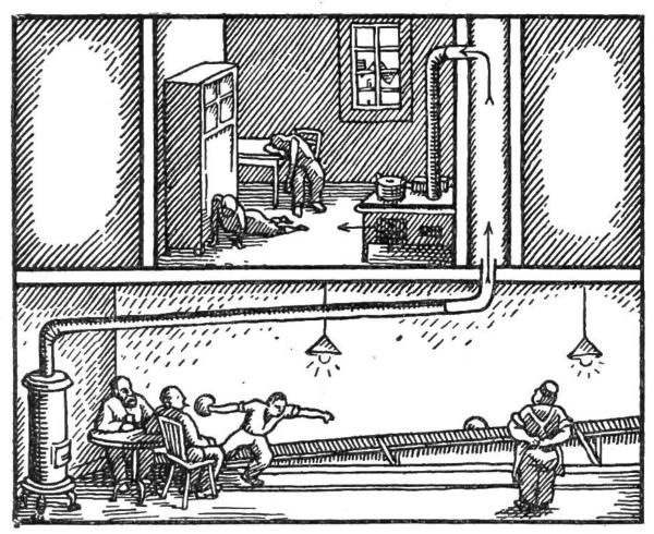
Tödliche Kohlenoxydvergiftung infolge Austretens der durch ein langes Ofenrohr abgekühlten Rauchgase durch einen an den gleichen Kamin angeschlossenen Kochherd.
