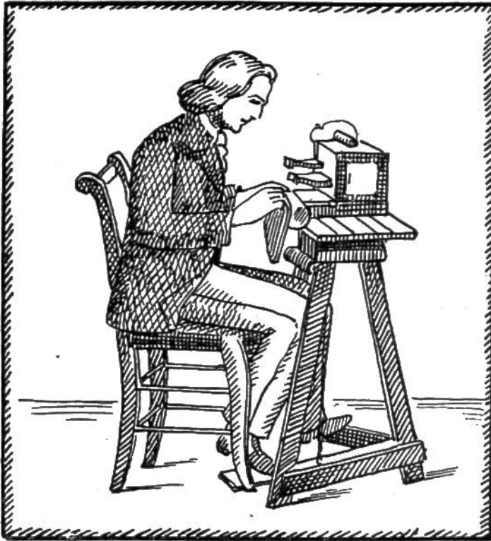
Thimonnier an seiner Kettenstich-Nähmaschine aus Holz (1830).
