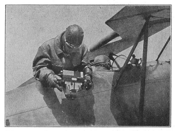
Flugzeug besatzung der eidgenössischen Landestopographie: Handhabung der besondern Flugzeugkamera bei Steilaufnahme aus freier Hand über Bord. Die Photographien werden zu Kartenzwecken "ausgewertet".
