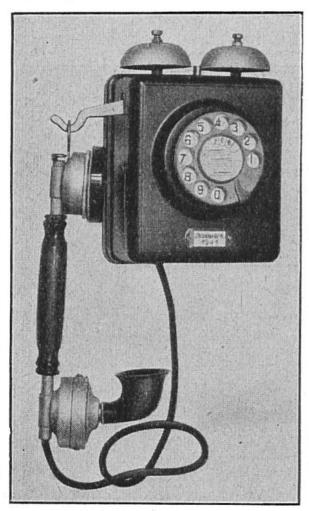
Ein Selbstanschlussapparat; Wandstation mit Mikrotelephon.
