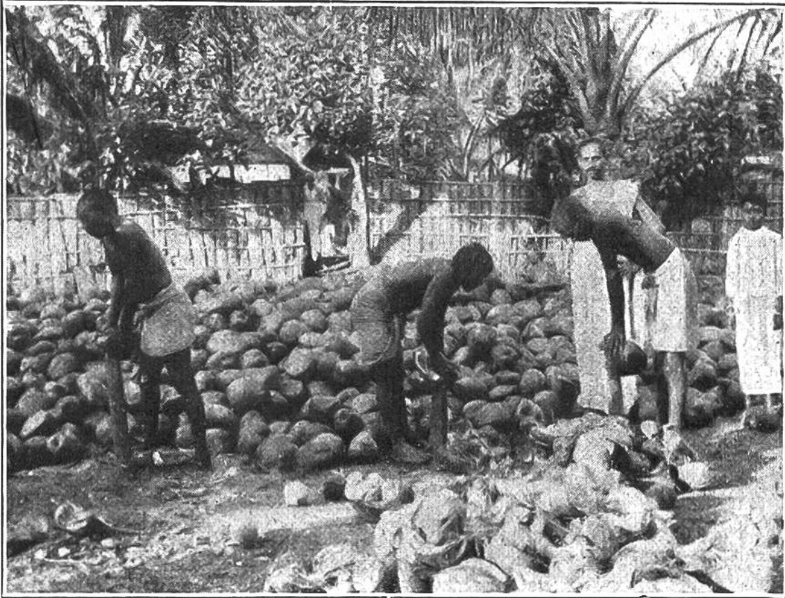
Herstellung von Kokosgarnen an der Malabarküste. Die Kokosnüsse werden gespalten und die Faserhülle, welche die Schale umgibt, losgetrennt.
