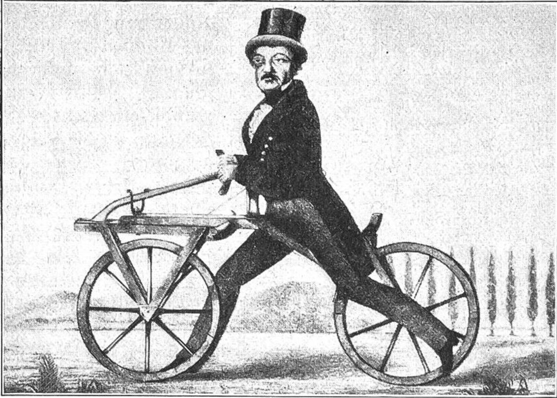
1817. Das LaufRad, eine Erfindung des badischen Freiherrn Drais von Sauerbronn, Forstmeisters und Professors der Mechanik.
