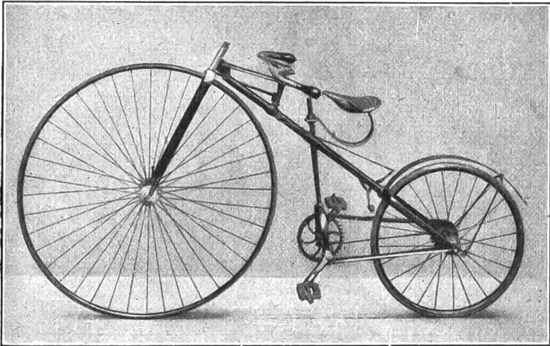
1879. Lawsons Fahrrad mit Kettenantrieb und 1\frac{1}{2} facher Übersetzung.
