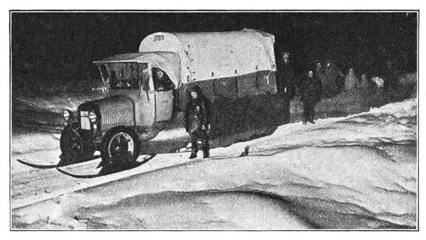
Raupenpostautomobil mit angehängtem Schneepflug, bereit zur Abfahrt. Die Leistungen sind verblüffend. Durch meterhohen Schnee kann eine 4—5 m breite Sahrbahn freigelegt werden.
