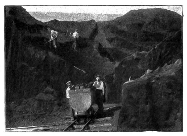
Braunkohlen = Tagebau. Die mit Spithaden losgehauene Kohle rollt in Wagen herunter und gelangt darin nach der Brikettfabrik.
