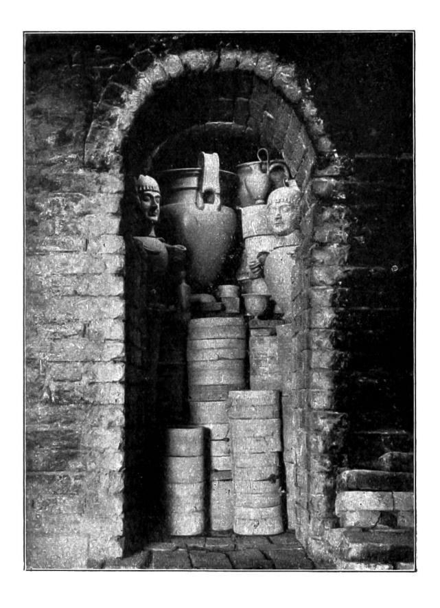
Der Brennofen mit den zu brennenden Tonwaren vor dem Dermauern. In den schachtelförmigen Zylindern befinsen sich die kleineren Gegenstände, die weniger hiße gebrauchen.
