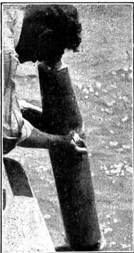
Ein Sernrohr für Untersee-Beobachtungen bis zu einer Tiefe von hundert Metern.
