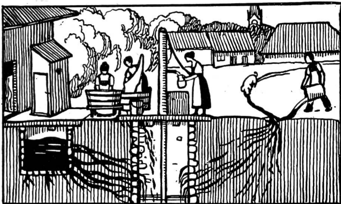
Derunreinigungsmöglichkeiten eines Sodbrunnens. Die Jauche dringt in den untern Teil des Brunnenschachtes und verseucht das Wasser mit Typhus- und andern Krankheitskeimen.
