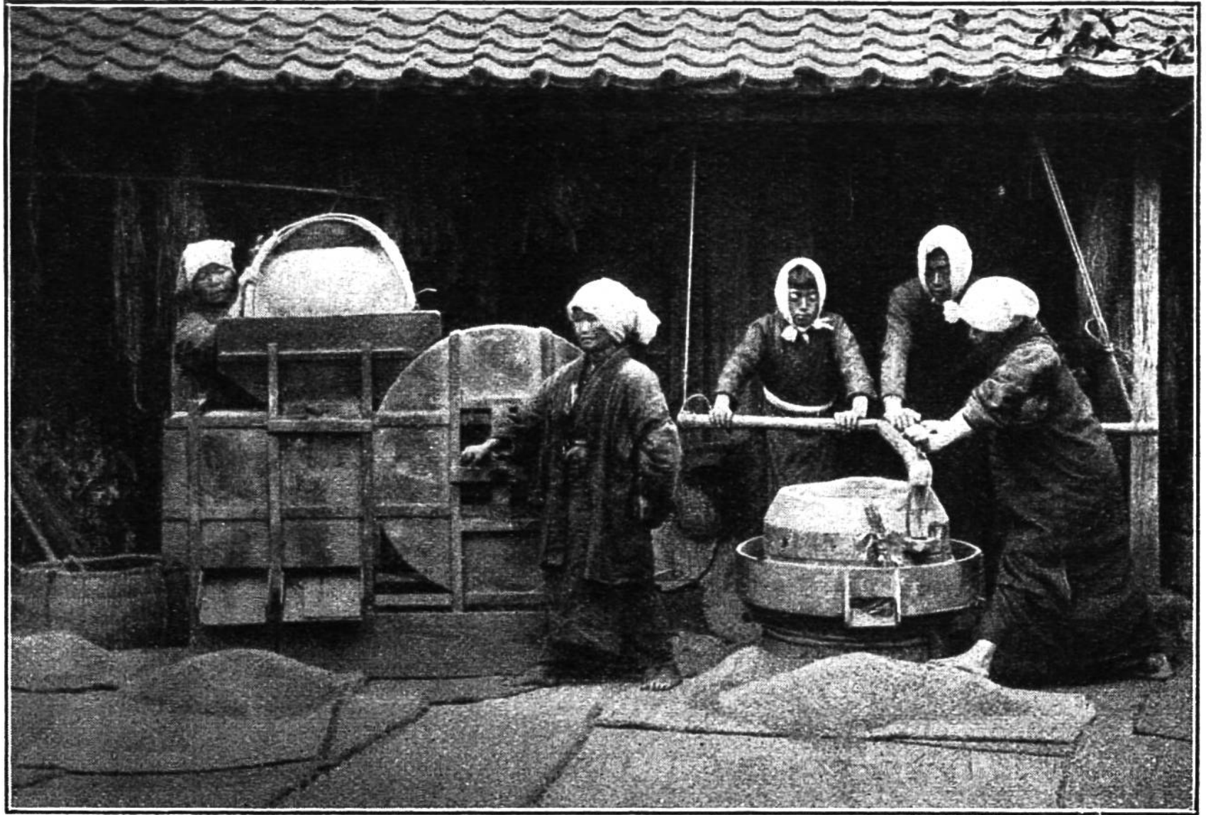
Der Reis wird in Mühlen mit hand= betrieb geschält und gereinigt.
