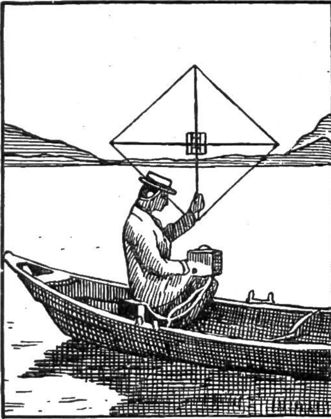
Kleiner tragbarer Apparat zum Abhören drahtloser Telegramme von allen Großstationen der Erde.
