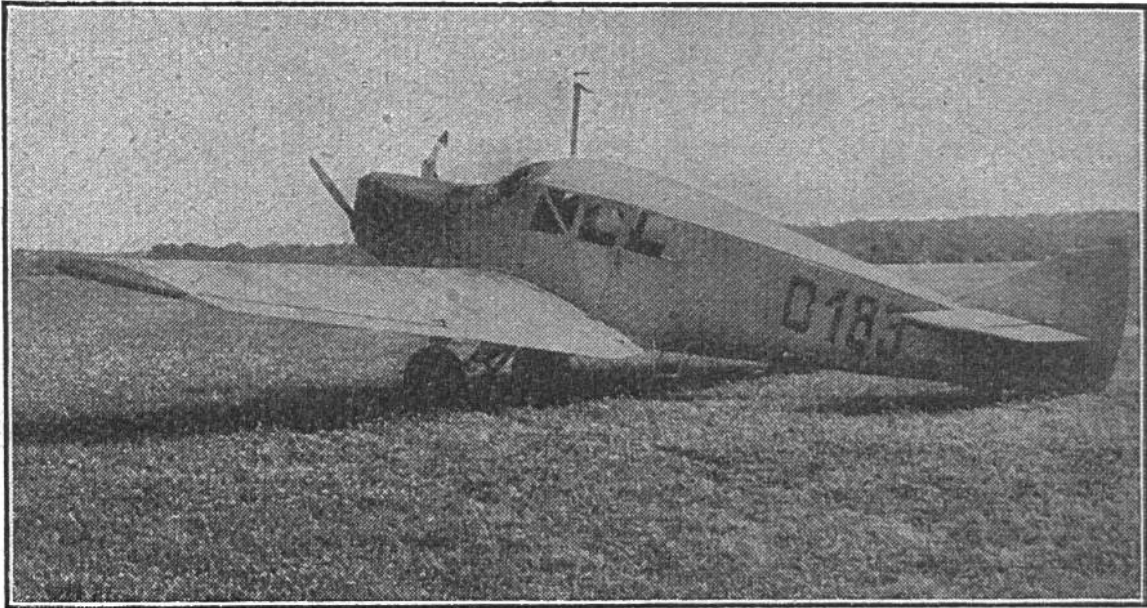
„Junkers“ Verkehrs-Eindecker mit frei tragenden Flügeln. Vollständig aus Dur-Aluminium.
