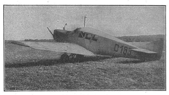
"Junkers" Derkehrs-Eindeder mit frei tragenden Slügeln. Dollskändig aus Dur-Aluminium.
