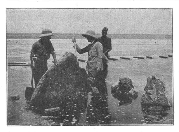
Sodasee nach der Regenzeit, mit Wasser bedeckt. Ingenieure heben Blöcke, um Proben zu entnehmen.
