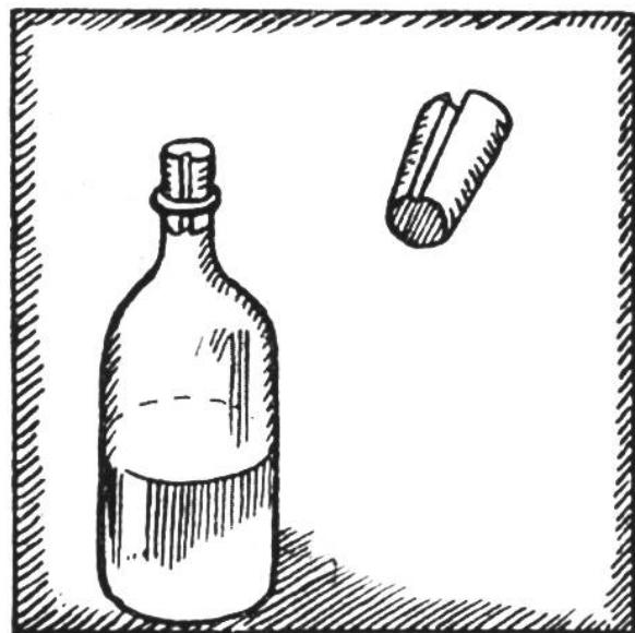
Nimm eine gewöhnliche kleinere Flasche und einen Korkzapfen; schneide in den Zapfen eine Rinne (siehe Abbildung) und stecke ihn dann fest auf die mit Mundwasser gefüllte Flasche. Wenn man die Flasche umdreht, so fliesst die Flüssigkeit tropfenweise durch die Rinne heraus wie bei einem gekauften Mundwasserfläschchen.
