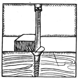
Wenn eine Schraube zu fest in hartem Holz steckt und vielleicht darin eingerostet ist, so kommt es nicht selten vor, dass bei gewaltsamen Bemühungen, sie herauszudrehen, eine Hälfte des Kopfes abspringt; dann greift der Schraubenzieher überhaupt nicht mehr an. Um die Schwierigkeit zu beheben, nehme man einen kleinen Block aus Holz oder Metall und presse ihn gegen
