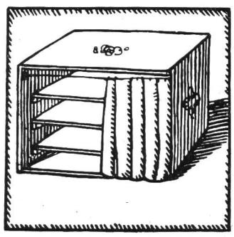
Oft fehlt im Haushalt eine geeignete Unterkunft für Schuhe und Putzzeug. Auf einfache Art kann man sich einen praktischen Kasten dazu anfertigen. Man stellt eine Kiste mit der offenen Seite gegen vorn. Auf den seitlichen Innenwänden werden Leisten befestigt, worauf die Bretter verschiebbar sind. Zur Verschönerung kann das Gestell angestrichen, d. h. bemalt und vorn mit einem
