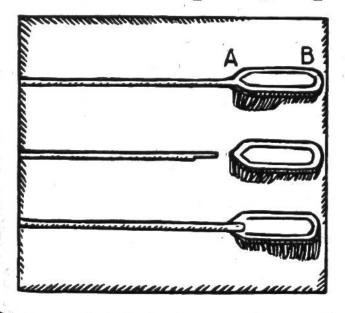
Wenn der Wischer vorn abgebraucht ist, so sägt man bei A den Stiel entzwei und flacht ihn vorn etwa 4 cm ab, wie das nebenstehende Bild zeigt. Dieses Ende wird nun bei B aufgenagelt. Man erreicht dadurch, dass die noch mit Borsten versehene Seite nach vorn gekehrt wird.
