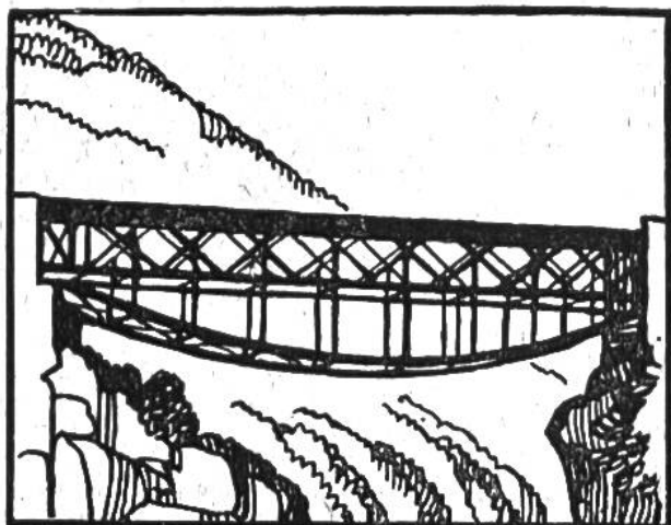
Brücke mit unter der Fahrbahn angebrachtem Balkenwerk und Bogen, das ebenfalls die Tragfähigkeit erhöht.
