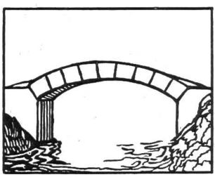
Beidseitige Träger zur Aufnahme des mehr seitlich wirkenden Gewölbedruckes (Schub) bei weitgespanntem Gewölbe.
