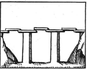
Auslegerbrücke mit Mittelpfeiler nach dem gleichen Prinzip.
