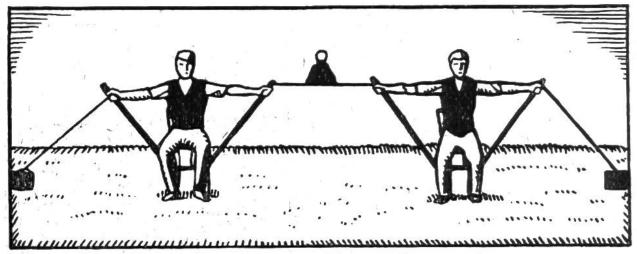
Schematische Darstellung der Kräfteverteilung bei einer nach dem Auslegerprinzip gebauten Brücke. Auf beiden Seiten sind zwei Verankerungen. Die Belastung in der Mitte wird auf die schrägen Träger abgeladen und von den beiden Personen nicht verspürt.
