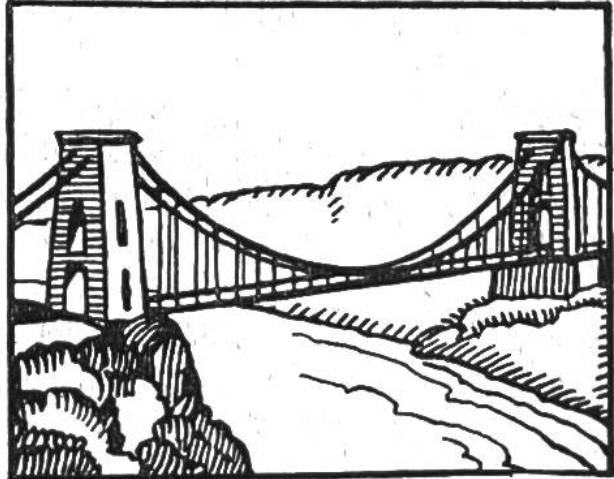
Aufhängen der Fahrbahn an Drahtseilen.
