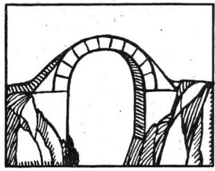
Beidseitige Träger und Verstärkungen zur Aufnahme des Gewölbedruckes bei einem Halbkreisgewölbe.
