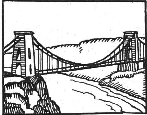
Aufhängen der Fahrbahn an Drahtseilen.
