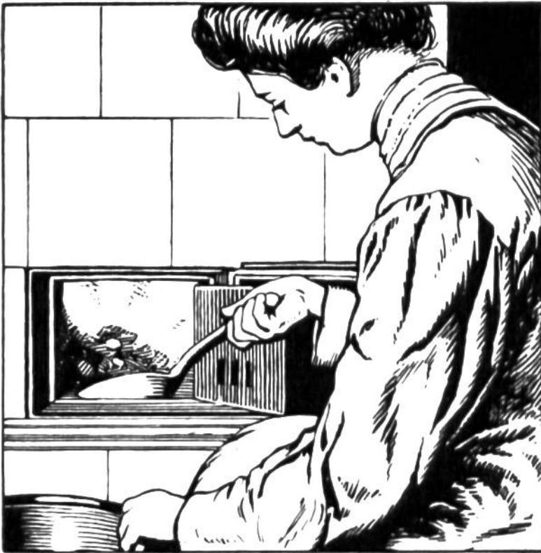
Wie man heizen soll. Der aus den vorne aufgelegten Kohlen aufsteigende Rauch, welcher viele Brenngase enthält, wird durch die hinten im Ofenraum befindliche Glut verzehrt.
