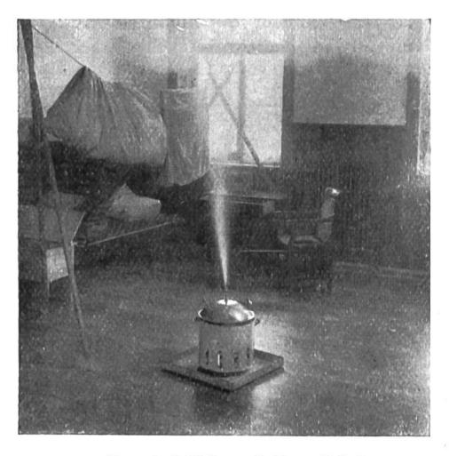
Raumdesinfektion mit Formaldehyd. Flügg'scher Desinfektionsapparat in Tätigkeit.
