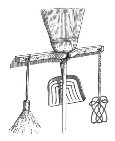
von der Breite des Besenstiels und weite dahinter ein ovales Loch aus. Darunter drehe einen gebogenen Haken für die Schaufel ein, ferner zwei aufrechte Haken an den beiden Enden für Staubwischer und Teppichklopfer und befestige das Ganze an geeignetem Orte mit zwei Schrauben an der Wand. Die Mutter wird dir für diese praktische Hilfe dankbar sein.
