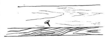
die Fasern des Holzes laufen und dann den Nagel quer zu dem Verlauf der Fasern einschlägt.
