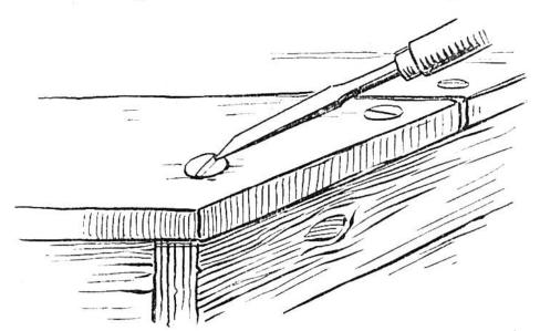
Rinne setzt, aber nicht in die Mitte, sondern an das äusserste Ende, wie das Bild zeigt. Mit einem Hammer schlägt man dann auf den Meissel, den man je nach der Drehung der Schraube nachschiebt.
