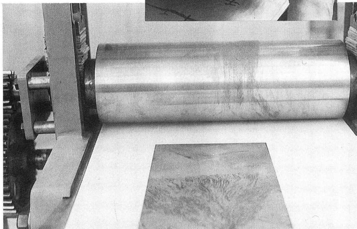
Am Schluss kommt Platte um Platte auf den Tisch der Druckpresse. Ein Passer ermöglicht sehr genaues Drucken auf dem angefeuchten Kupferdruckpapier, das die Farben aus der Tiefe «aufsaugt». Erst jetzt sieht der Künstler Walter Ehrismann das fertige Bild. ●
