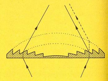
Das Querschnitt-Schema macht's deutlich: die Oberseite einer jeden Stufe der Ringlinse ist ein Ausschnitt aus der Wölbung der entsprechenden konventionellen Linse. Die Tiefersetzung der Strahlenaustrittspunkte führt jedoch zu einer Parallelverschiebung der austretenden Strahlen. Damit diese sich trotzdem in einem Brennpunkt treffen, sind gewisse Korrekturen an der Stufenlinse nötig.
