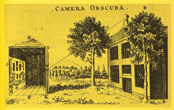
Das Prinzip der Camera obscura in einer alten Darstellung: Die vom Gebäude rechts ausgehenden Lichtstrahlen können nur ins Innere der Lochkamera (links) gelangen, indem sie sich im Bereiche der mit V bezeichneten kleinen Öffnung kreuzen. Deshalb steht das an die Rückwand der Camera obscura projizierte Abbild auf dem Kopf.
