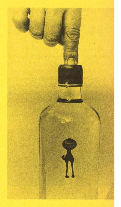
Der auf den Gummipfropfen ausgeübte Fingerdruck überträgt sich auf das Wasser in der Flasche. Der mit einer Öffnung versehene kartesianische Taucher füllt sich dadurch stärker, verliert an Auftrieb und sinkt.
