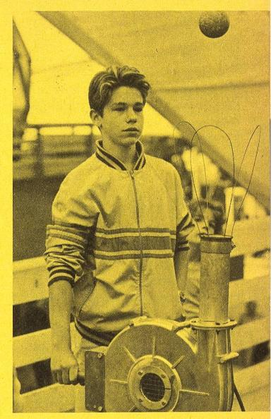
Der Luftstrom mit dem in ihm schwebenden Ball lässt sich um einen beträchtlichen Winkel aus der Senkrechten auslenken. Der Ball fällt erst dann aus der Strömung, wenn die Erdanziehung (Schwerkraft) die «einmittende» Kraft überwiegt.
