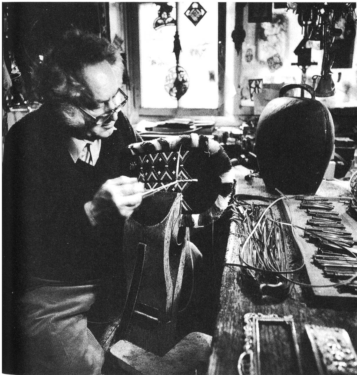
Der Schmuckbeschlag wird mit verschiedenen Punzen ziseliert.
