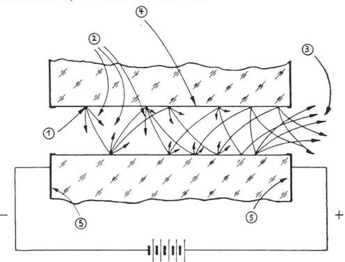
Schnitt durch einen Mikrokanal. Ein Primärelektron von der Photokathode (1) trifft auf die Kanalwand. Es schlägt Sekundärelektronen (2) frei. Diese bewegen sich im Zickzack durch den Kanal, schlagen wiederholt in die Kanalwand (4), setzen bei jedem Auftreffen weitere Elektronen frei und treten schliesslich als Elektronengarbe (3) aus. Die an den leitend bedampften Endflächen der Platte angelegte Spannung (5) zwingt die Elektronen auf ihren Weg durch die Kanäle.
