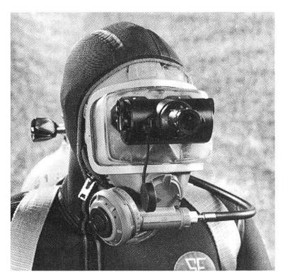
Die Taucher-Nachtsehbrille BIG 21, eine Weltneuheit, bringt gute Sicht sogar bei absoluter Dunkelheit. Eine eingebaute Leuchtdiode sendet infrarotes Licht aus, das von der Bildverstärkerröhre wahrgenommen wird.
