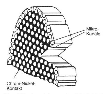
Die Mikrokanalplatte, in Wirklichkeit knapp 1 mm dick, besteht aus einer speziellen halbleitenden Glasart mit der Fähigkeit, beim Auftreffen eines Elektrons Sekundärelektronen auszusenden.
