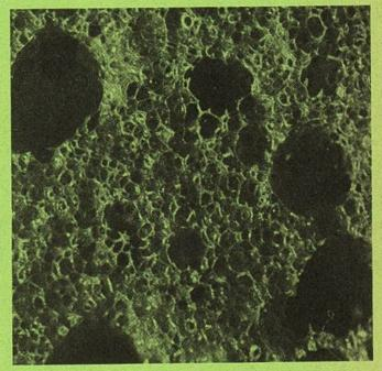
Schaumstoff oder Brot? Jedenfalls ist die Oberfläche dank der Blasenstruktur besonders gross. Brot wird dadurch leichter verdaulich, der Schaumstoff isoliert — dank der eingeschlossenen Luft — besonders wirksam.
