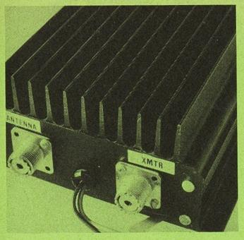
Hier muss gekühlt werden. Die Metallrippen vergrössern die Oberfläche; so kann sie viel Wärme an die Luft ableiten.
