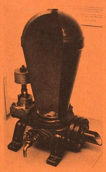
Eine Pumpe ohne Kolben ist der Hydraulische Widder. Stossweise — daher die
