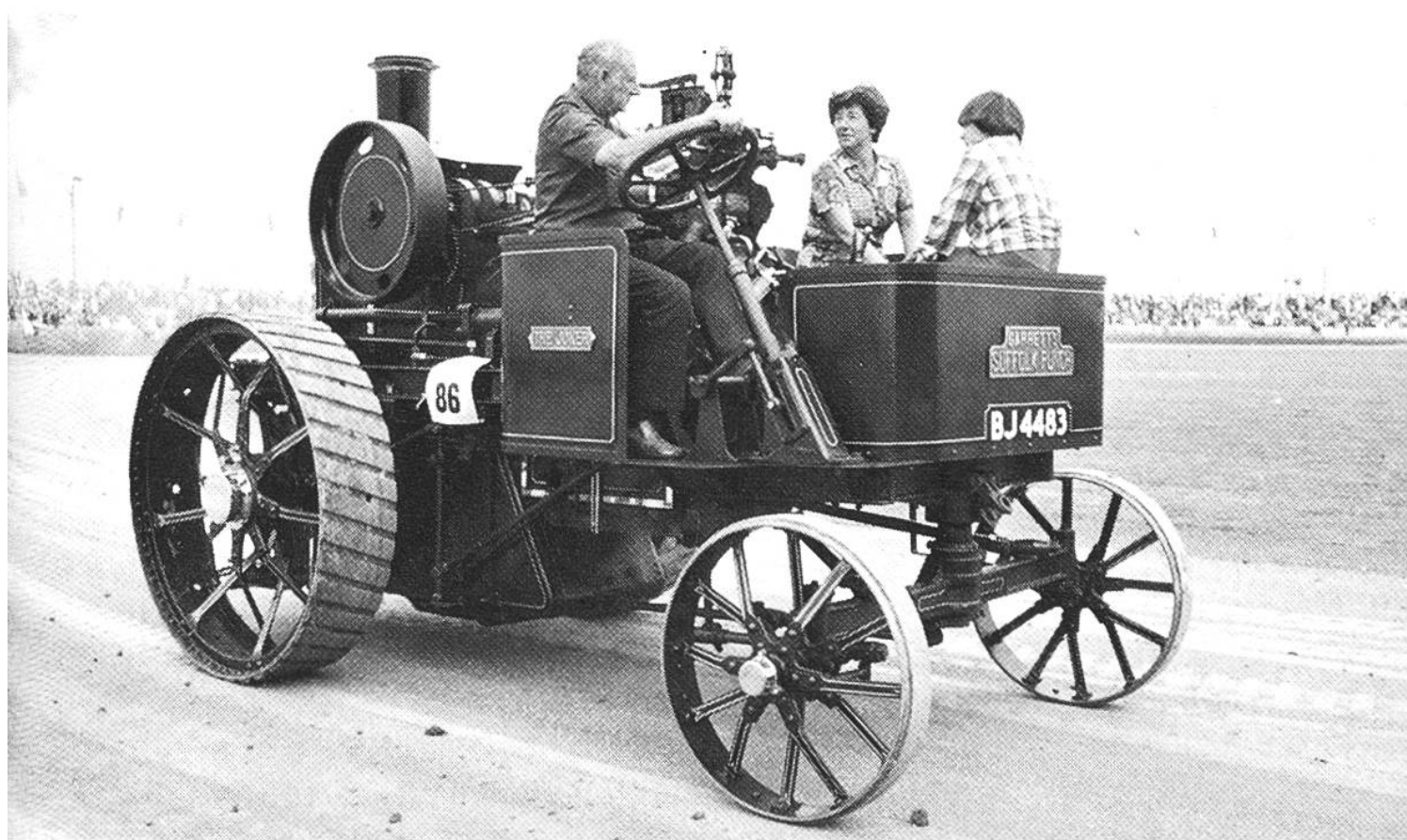
Eine besonders wendige Mehrzweckloki. Ihr Boiler befindet sich hinten.
