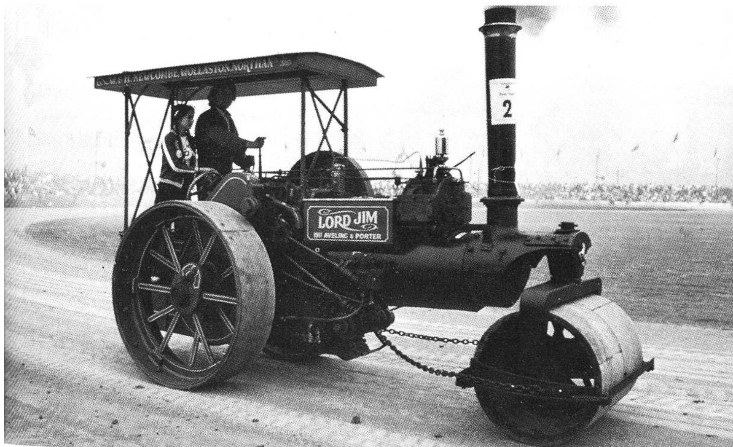
Diese Strassenwalze wird über Ketten gelenkt.
