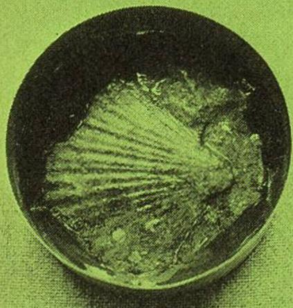
4./5. Die hübsche Versteinerung aus Jurakalk wird in einer Blechdose in Gips eingebettet. Nach dem vollständigen Austrocknen könnte man die so vorbereitete Form in Zinn oder Blei abgießen. Ungenügend getrocknete Vorlagen rufen im Metallguss Dampfblasen hervor.
